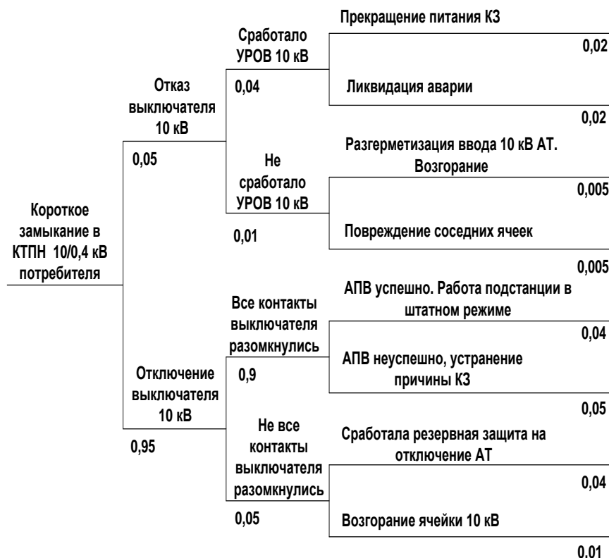
Рис. 2 - «Дерево событий» аварии на КТП 10/0,4 кВ
