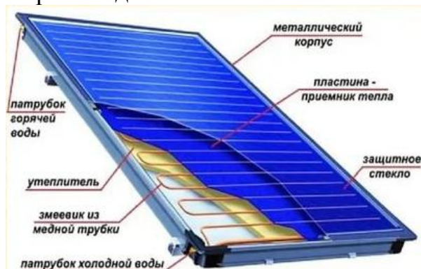
Рис. 1 - Конструкция плоского солнечного коллектора
